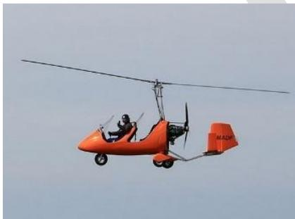
Ganz ausgefallen, und kaum jemandem bekannt, das nächste Fahrzeug, mit dem er sich auf einer höheren Ebene bewegt und „Übers Rheingau im Gyrocopter“ entschwebt. Der Tragschrauber ist ein Drehflügler bei dem die Rotorachse leicht nach hinten geneigt ist und mit dem Vorwärtsschub das Gerät mit einem großen Propeller in die Höhe treibt. Antarktische Kleidung schützt ihn vor dem kalten Wind und so kann er eifrig Luftaufnahmen sammeln. Das Motorgeräusch war die einzige
