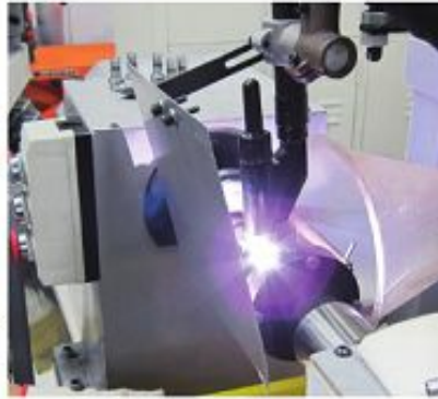
Schweißen von Magnetrohren
