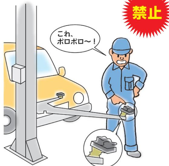
使用中に破損しアタッチメントが外れ、車両が落下する危険
