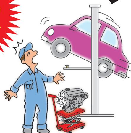
極端な偏荷重や重量物の脱着による荷重バランスの崩れに注意しましょう。
