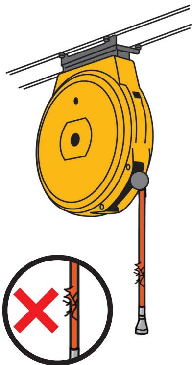
エアホースの破裂によりチャックが
