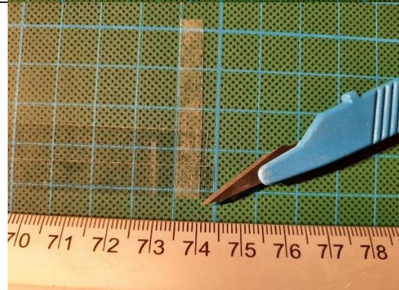
Mit etwas Überlänge so auf die Ruder kleben, dass die Kante zwischen klebend und nicht klebend genau an der Ruderkante liegt:
