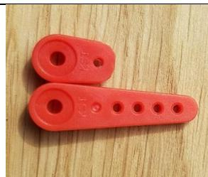
Die Gabelköpfe werden z.B. mit einem Dremel mit Schleifkopf modifiziert, um trotz Einhängen nah an der Drehachse ausreichend Servoweg (+-45°) zu erreichen.
