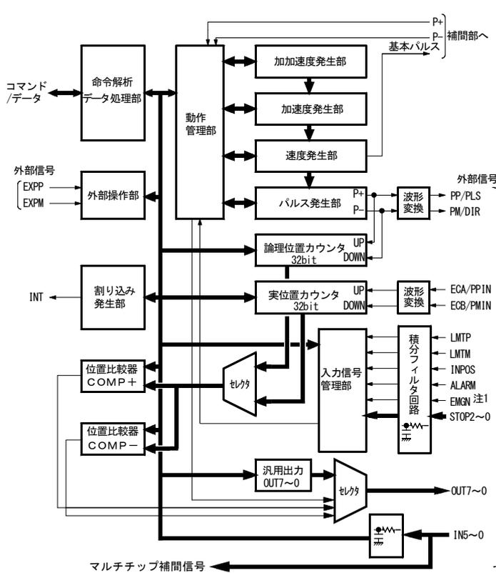
X, Y-軸制御部 機能ブロック図 (各軸共通)
