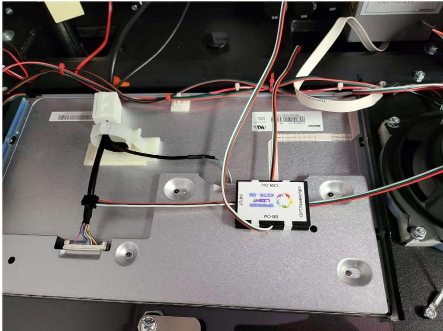
Platzieren sie die Verteilerbox auf der Rückseite des Bildschirmes. Dadurch kann über den optionalen Ausgang auch die Speakerlights mit in das System integriert werden.
