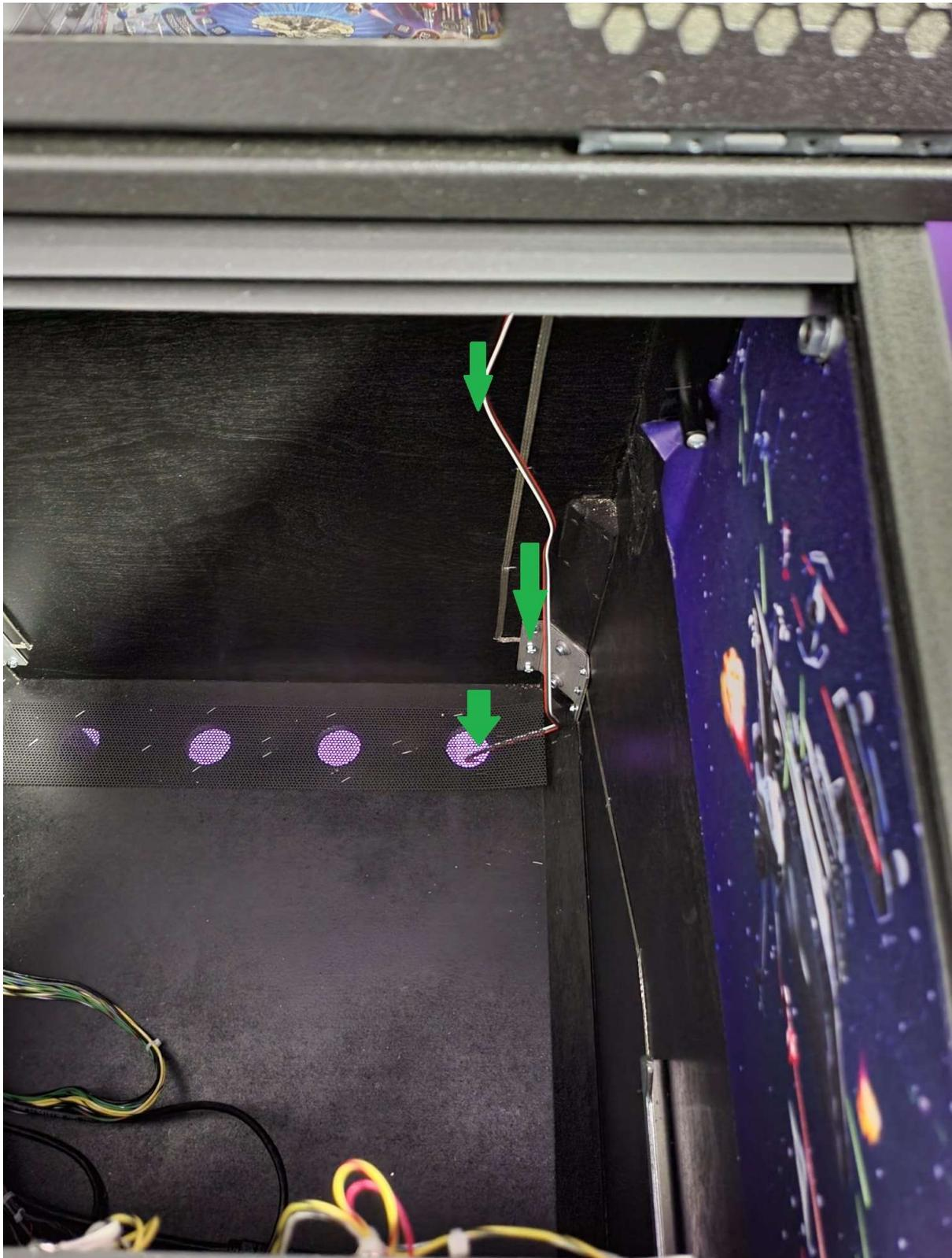
Das Kabel mit der Bezeichnung CAB-Out nach unten verlegen, und durch das Belüftungsloch nach außen führen.
