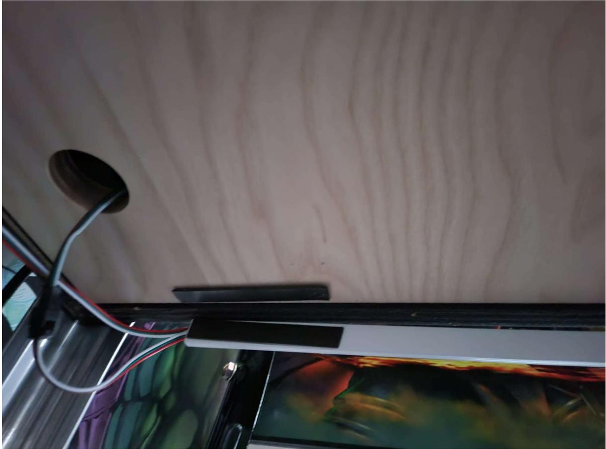
Die Montage Stellen für die Under-Cab Beleuchtung unter dem Flipper reinigen, damit die Fläche von Staub oder Verunreinigungen befreit ist.
