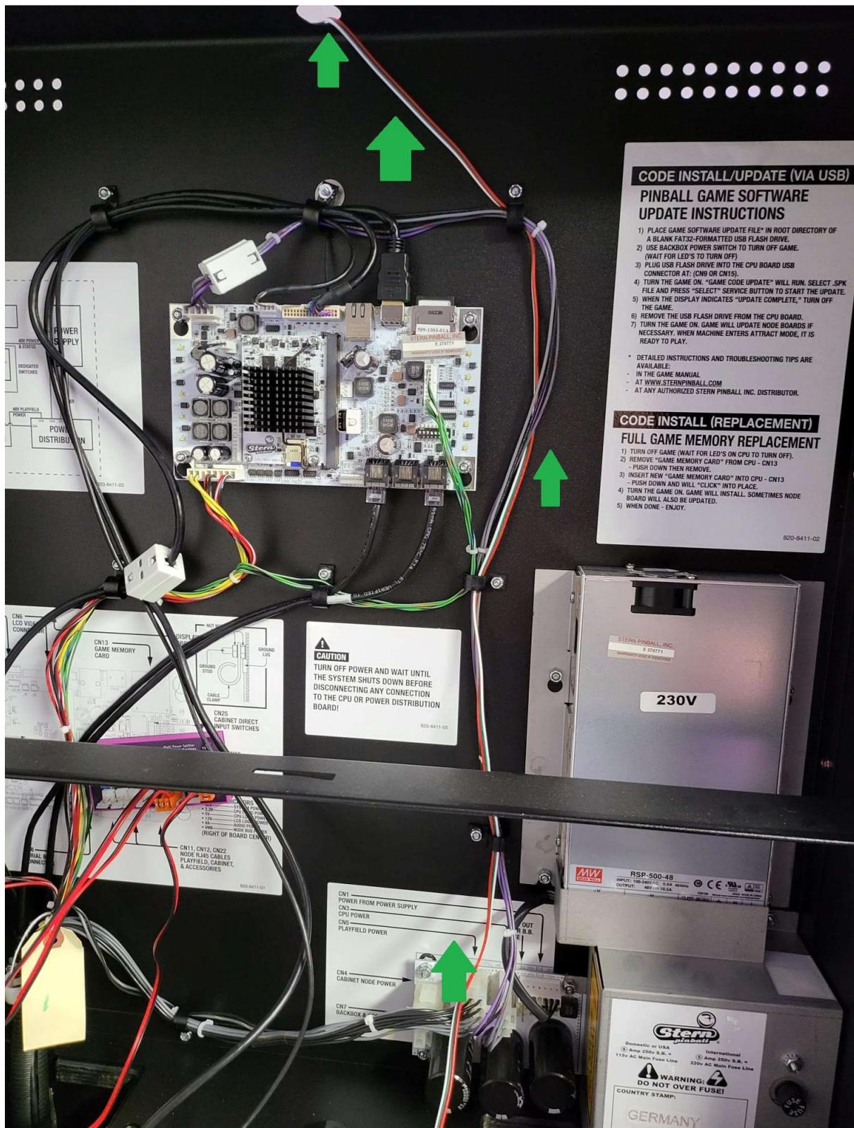
Das Kabel mit der Bezeichnung BB-Out in der Backbox verlegen, und durch die obere Öffnung der Backbox rausführen.
