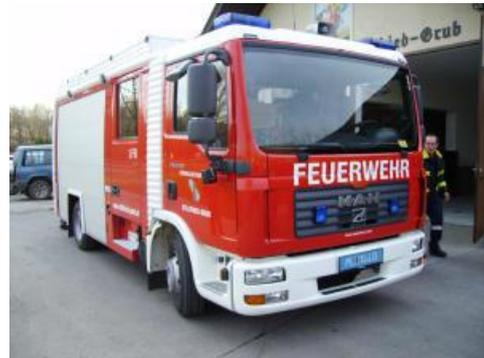
HLF 2 – Hilfeleistungsfahrzeug 2 mit 2000 Liter Wasser
