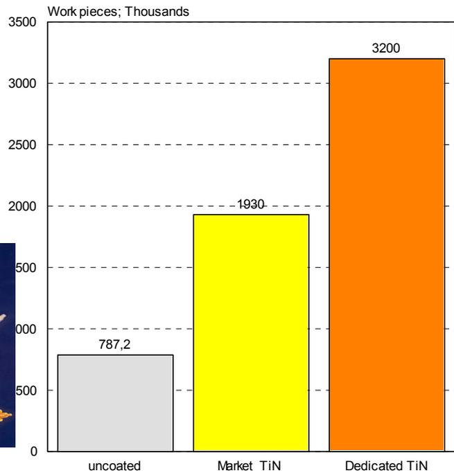
Work piece mat.: Polyamide 6.6 50% FV - Tool Mat.: Z38CDV5 - HRC 52-53
