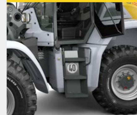
Die Fahrerkabine ist über die beidseitig, großzügig gestalteten Einstiegsbereiche über drei treppenartige Stufen zu erreichen. Vier Haltegriffe (einer links an der A-Säule, zwei am Treppenaufstieg und einer an der Tür) ermöglichen einen sicheren Ein- und Ausstieg auf beiden Seiten. Auch eine Innenraumbeleuchtung mit Türkontakt-schalter ist vorhanden.
