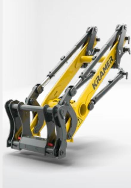
Die P-Kinematik überzeugt mit hoher Losbrechkraft, hohen Haltekräften im oberen Bereich des Hubgerüsts und einer beispielhaften Präzision beim Arbeiten mit schweren Lasten. Dieser Vorteil macht sich vor allem bei Be- und Entladearbeiten sowie bei Stapelarbeiten mit hohen Hubhöhen bemerkbar.
