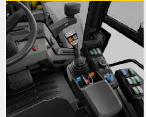
Die Armlehne, inkl. Joystick-Konsole und Jog Dial, ist am Fahrersitz montiert und mit den wichtigsten Bedienelementen ausgestattet. Somit kann die linke Hand am Lenkrad und die rechte Hand im Bereich der Armlehne bleiben. Die Armlehne ist hochklappbar und ermöglicht somit auch einen Ausstieg nach rechts.
