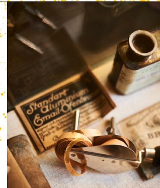
Gold von der Rolle: Mit diesem Werkzeug können Bilderrahmen mit einem fortlaufenden Streifen verziert werden
