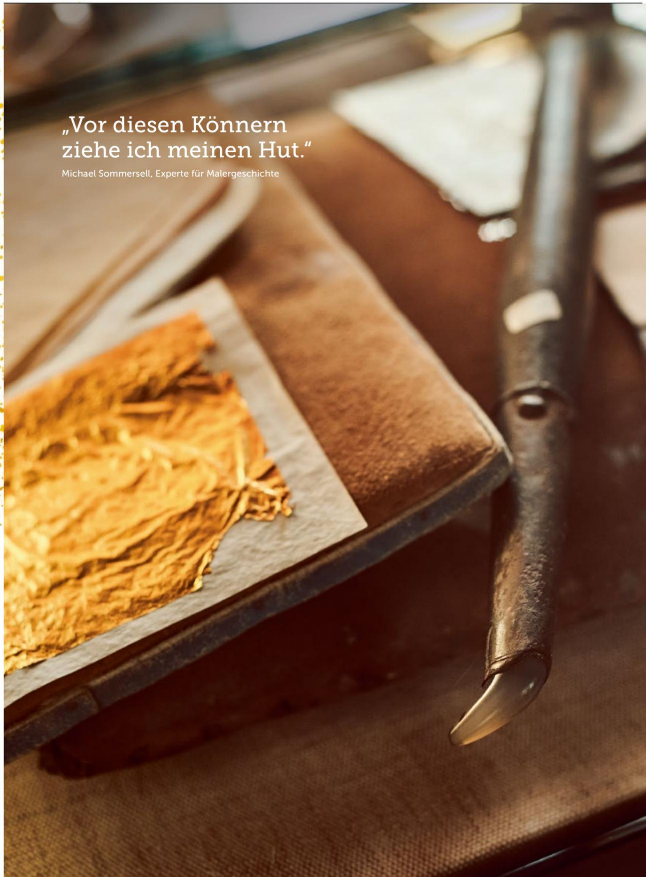
Mittelalterliches Vergoldungbesteck: Lederkissen, Messer und Metallfinger mit Achat-Kralle dieser Art werden noch heute für die Polimentvergoldung eingesetzt. Günstiger als diese Methode ist die Ölvergoldung, die sich auch für den Außenbereich eignet
