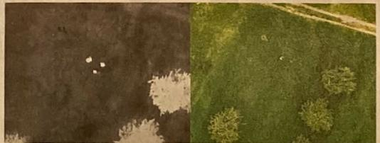
Mit einer Wärmebildkamera lassen sich die Tiere (links) gut erkennen. Rechts im Vergleich das Bild aufgenommen mit einer normalen Kamera.
