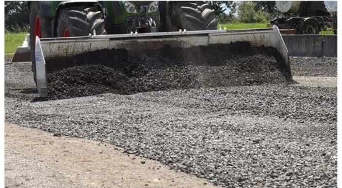
Das Stehr Frontplanierschild SPS 25 /40 angebaut an Traktoren ab 200 PS.
