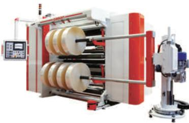
**SLITTER / UMROLLER / ROLLENSCHNEIDER** von 100m/Min bis zu 1.200m/Min. Mit CASON, Italien und FLEXOTEC, Spanien werden alle Anforderungen an BUDGET und LEISTUNG bedient. Umrollen, Schneiden, Lochen, Zusammen-Schweißen und alles was sie von einem Slitter-System erwarten können. **KMB hat es**. Sei es für Folien, Verbundmaterialien, Gewebe, Papier, Luftpolster oder Agrar-Folien.
