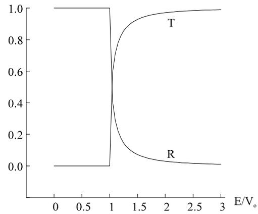
Coeficientes de transmisión y reflexión para un escalón de potencial.
