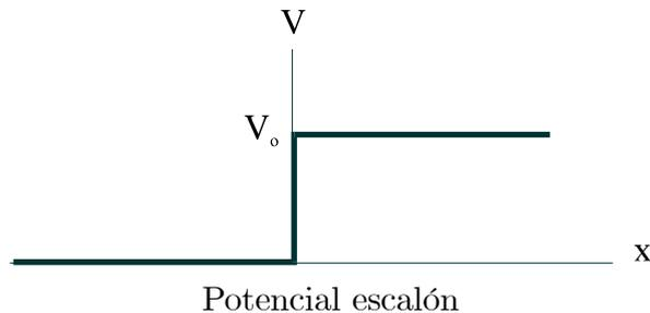
Este potencial sufre una discontinuidad en el punto  $x = 0$ . Este potencial se puede obtener mediante el dispositivo que se muestra en la figura. Se trata de dos cajas conductoras huecas que se encuentran a potenciales distintos, de modo que una partícula cargada estará sometida más o menos a un potencial escalón. El campo eléctrico en la unión de las dos cajas será muy intenso.
