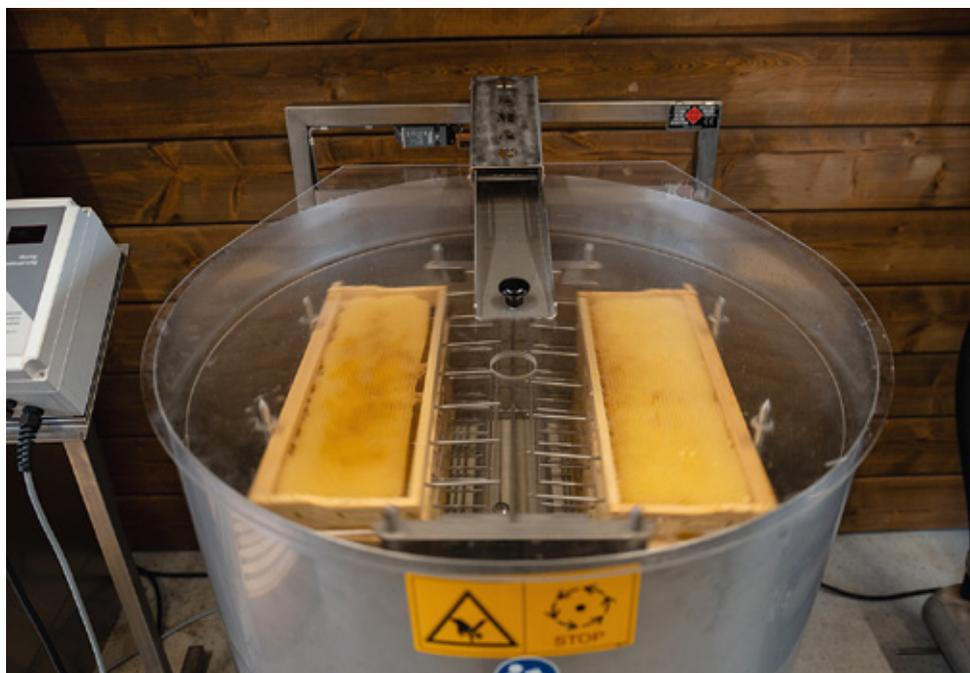
Dieses Gerät arbeitet bei der Honiggewinnung nicht nur auf Fliehkraftbasis wie alle herkömmlichen Honigschleudern, sondern hauptsächlich nach dem Venturi-Prinzip. Das heißt, dass der Honig durch die geregelte Luftführung im Kessel aus den Zellen abgesaugt wird.
