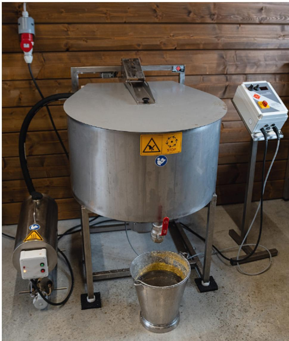
Hierbei werden so viele Waben hineingestellt, bis der Korb voll ist. Auch ausgeschnittene Waben, Deckelwachs oder Wachsböcke können eingeschmolzen werden. Da der Dampfraum im Kessel so klein wie möglich gehalten ist, ist für die Elektroheizung nur eine Leistung von 6 kW erforderlich.
