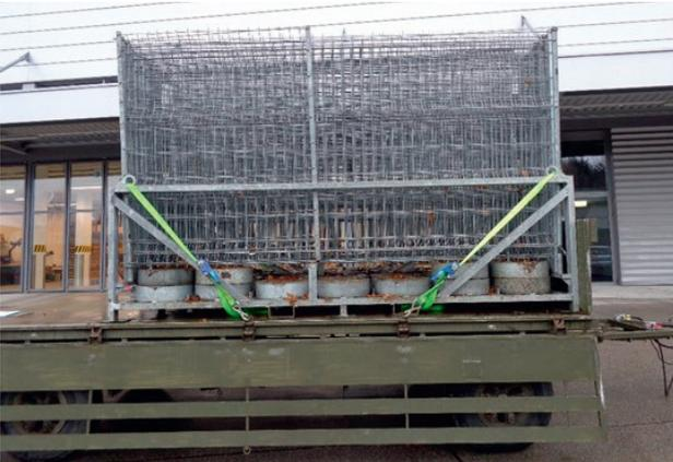
Abbildung 5: Seitenansicht formschlüssiger Verlad an Stirnwand Anh 85
