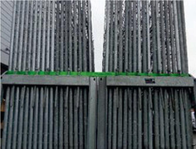
Abbildung 23: Heckansicht Anh 85 zwei Zaunelemente. Niederzurren.
