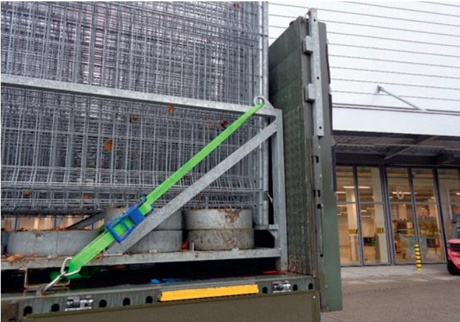
Abbildung 19: Ansicht Stirnwand von FLAT mit Bordwänden formschlüssig
