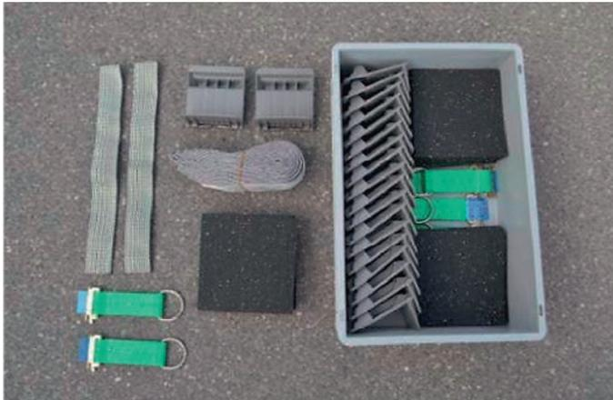
Abbildung 9: Kiste mit Sicherungsmaterial auf NLG
