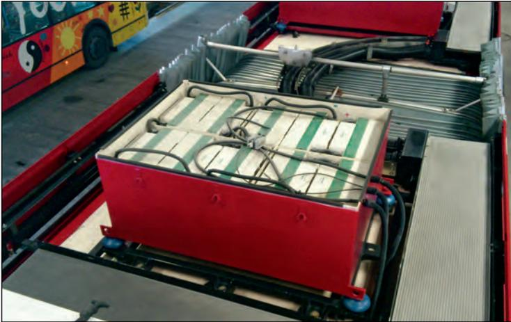
Abb. 2: Erste Versuche mit batteriebetriebenen Hilfsantrieben bei Obussen in Salzburg liefen nicht zufriedenstellend.
