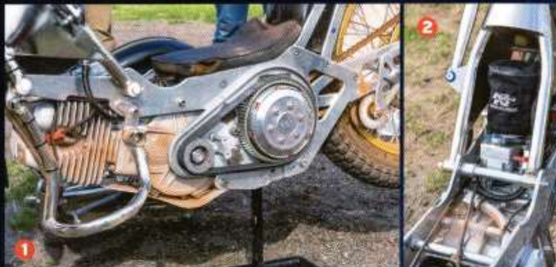
1 De liggende methanol-gestookte 500cc eencilinder GM is via een belt-drive en droge koppeling verbonden met de losse twee-versnellingsbak. 2 Per heat van vier rondes gaat er tussen 0,5 en 2 liter methanol door de speciale Blixt-carburateur.
