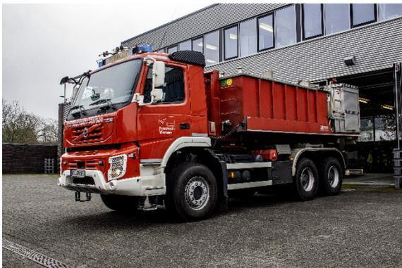
**Wechselladerfahrzeug mit Abrollbehälter Wasser**
