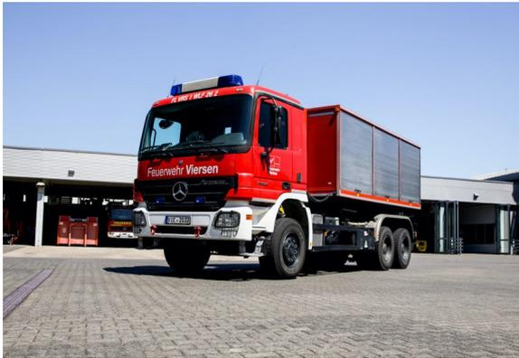
**Wechselladerfahrzeug mit Abrollbehälter Gefahrgut**
