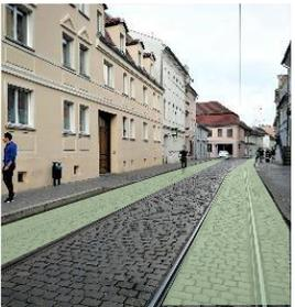
**Beschluss 216/2009:** Einbau **Angebotsstreifen für Radfahrer**, indem der vorhandene Belag gegen einen ebenen Naturstein (geschnittenes und gestocktes Großpflaster) ausgetauscht wird
