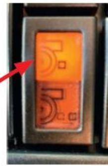
Kontrollleuchte leuchtet: Unterfahrschutz komplett eingefahren
