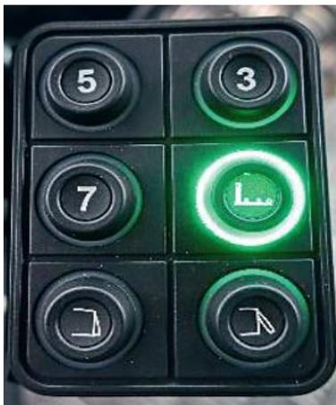
Das Hakengerät muss über diese Taste aktiviert werden:
