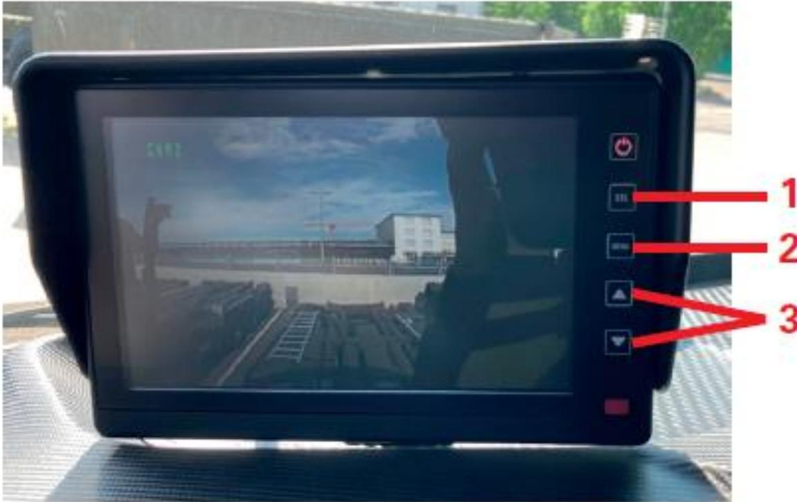
Der Monitor wird bei **eingelegtem Rückwärtsgang** oder **zugeschaltetem Nebenantrieb** automatisch aktiviert. Sind sowohl Rückwärtsgang, als auch Nebenantrieb nicht mehr aktiv, so schaltet sich das Kamerasystem automatisch aus. Es kann in diesem Zustand manuell aktiviert werden.
