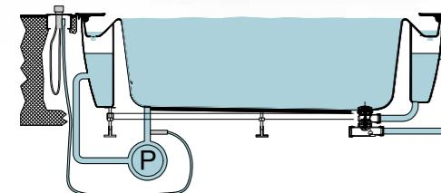
Versione Airpool con sistema con serbatoio integrato per il ricircolo dell'acqua.
