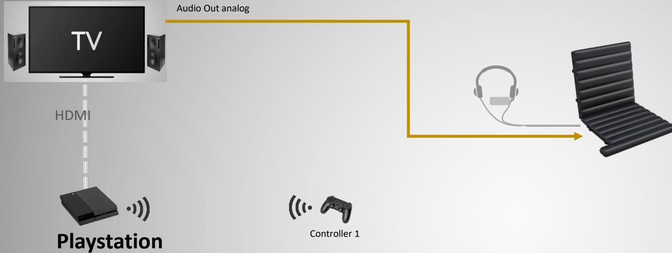
SF PX über Monitor / Bildschirm oder Kopfhörer anschließen
