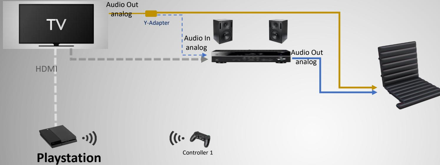
SF PX über AV Verstärker anschließen
