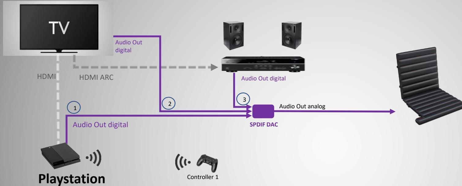
SF PX über SPDIF DAC aus Playstation, AV Verstärker, Monitor/Bildschirm anschließen
