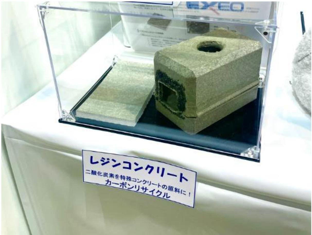
レジンコンクリートは特殊有コンクリートで、主にマンホールやトンネルの内壁、塩害の恐れが有る風力発電の基礎に使われる。
