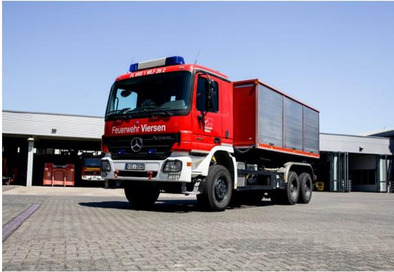
**Wechselladerfahrzeug mit Abrollbehälter Gefahrgut**
