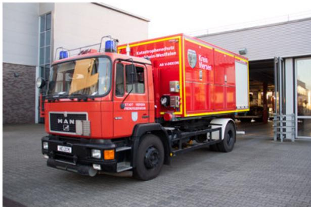
**Wechselladefahrzeug mit Abrollbehälter V-DEKON**
