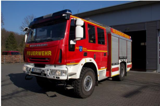
**Hilfeleistungslöschgruppenfahrzeug HLF 20/16**
