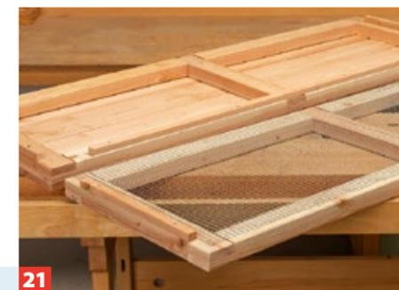
**21** Anschließend werden die Leisten auf der Unterseite der Deckel-Elemente geschraubt, damit die Deckel nicht verrutschen.
