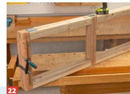
**22** Die zwei anderen Deckel-Elemente mit Kaninchendraht bestücken und mit Scharnieren bestücken.
