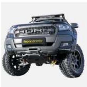
Seilwindensystem Alpha 4,3 Tonnen für Ford Ranger Baujahr 2016-2022
