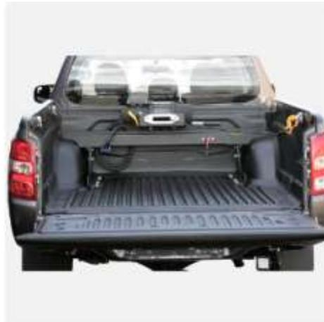
Heckwindenträger für Pickups mit Seilwinde und Kunststoffseil
