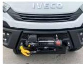
Seilwindensystem Alpha für Iveco Daily 4x4 - 5,4 Tonnen
