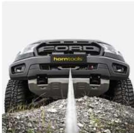
Seilwindensystem Alpha 4,3 Tonnen für Ford Ranger
