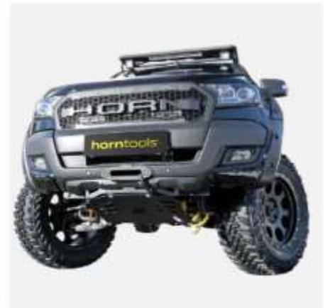
Seilwindensystem Alpha 4,3 Tonnen für Ford Ranger
