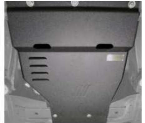
Getriebe Unterfahrerschutz für Ford Ranger Bj. 2011-2022
