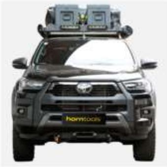
Seilwindensystem Alpha 4,3 Tonnen für Toyota Hilux Revo ab Bj. 2016
