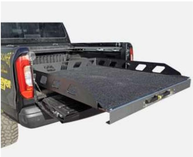
Um der hohen Gewichtsbelastung des Cargoslides gerecht zu werden, wurden die Verschlussbolzen in Werkzeugstahl ausgeführt. Dies garantiert, dass im Notfall auch einer der beiden Bolzen alleine der Nutzlast (ohne bleibende Schäden) standhält. Das Führungssystem besteht insgesamt aus 22 Kugellagern, alle Lager sind in isolierter Bauweise ausgeführt und trotzen so den Umwelteinflüssen.
