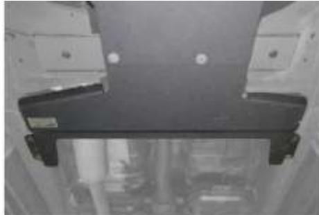
Verteilergetriebe Unterfahrerschutz für Ford Ranger T6 & T7 Bj. 2011 - 2022
