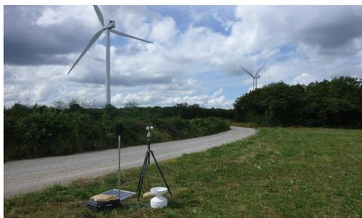
Installation des sonomètres près d'une éolienne
