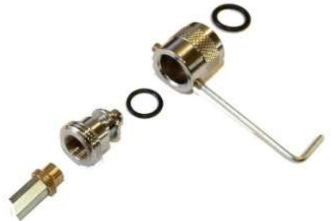
Die Luftzugabe erfolgt durch eine seitliche Bohrung im Innenteil nach dem Venturi-Prinzip. Für die stufenlose Einstellung muss das Innenteil aus dem Vario-Ventil gelöst werden. Durch die seitliche Bohrung entleert sich der Duschkopf nach Beendigung des Duschvorgangs.
