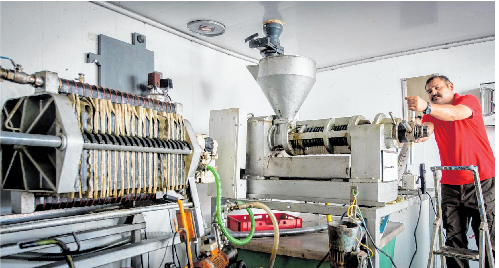
Voller Einsatz: Jörg Schweickert an seiner Ölmühle, mit der das Öl aus den Samen gepresst wird. | Bild: Thomas Neu
