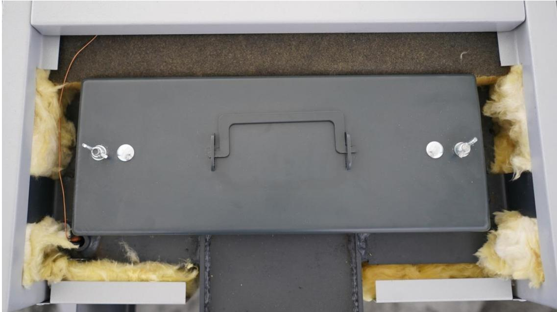
Flügelmuttern lösen und Abdeckung entfernen
