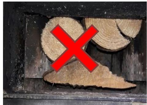
3. Nun kann die Brennkammer nach oben mit größeren Scheithölzern möglichst luftdicht vollgeschichtet werden. Dabei sollten die Größten Scheite nach oben gelegt werden!
