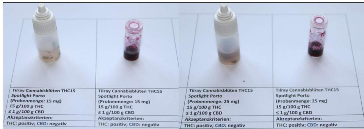
Abbildung 6: Fotos nach Durchführung des Tilray Quick-ID THC-/CBD-Schnelltests an der Tilray Cannabisblüten THC15 Spotlight Porto (Probenvolumen: 15 mg und 25 mg)
