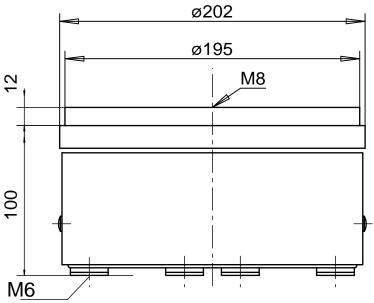
Gewicht ca 11.5Kg El.Leistung 100VA Schutzart IP54 4 Federpakete 2 Spulen
