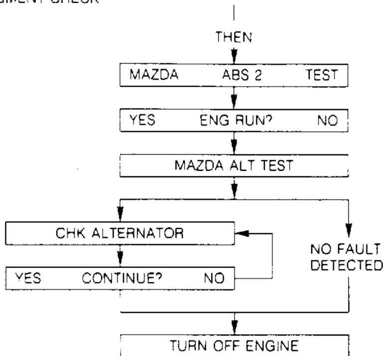
**Fig. 14: Test 2 Alternator Test**
