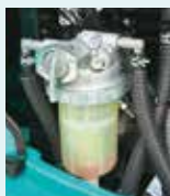
Kraftstoffvorfilter mit eingebautem Wasserabscheider
