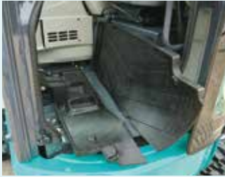
Zweiteilige Bodenmatte für einfache Reinigung
