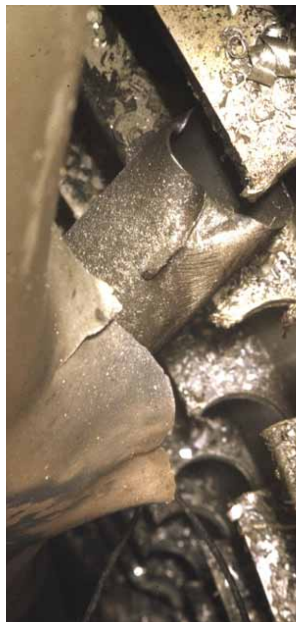
Gesprengtes Brennstabhüllrohr in Lucens Quelle ENSI
