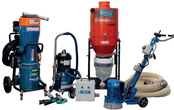
Abschleifen von asbesthaltigen Bitumklebern von mineralischem Untergrund.
