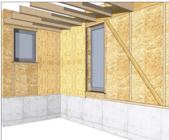
Innere Bekleidung/Aussteifungsmöglichkeiten: links Holzwerkstoffplatte (z. B. 3-Schicht-Platte), rechts Holzstrebe; jeweils zwei Strohballen nebeneinander hochkant im Gefach stehend
