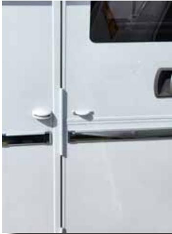
Fast alle Wohnmobile und Wohnwagen benutzen Türfeststeller. Diese Feststeller bestehen aus zwei Komponenten, die an Tür und Kabine geschraubt oder verklebt sind. Aus Gewichtsgründen werden die meisten Kabinen aus Sandwichplatten hergestellt. Ob es zweckmäßig ist einen Feststeller in einer Sandwichplatte zu verschrauben, sei dahingestellt.
