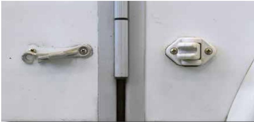
Das linke Bild zeigt einen Türbefestiger nach intensiver Benutzung. Es ist offensichtlich, der Feststeller muss ausgetauscht werden. Beim Wechsel treten all die bekannten Probleme wie Schraubenpassung, Rost, etc. auf.
