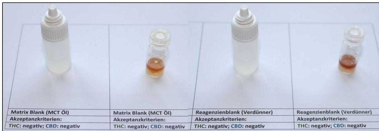
Abbildung 5: Fotos nach Durchführung des Tilray Quick-ID THC-/CBD-Schnelltests mit Matrix-Blank (MCT-Öl) und Reagenzien-Blank (Verdüner)
