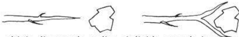
ghiaia di cava: la radice si divide quando incontra la superficie tagliente
