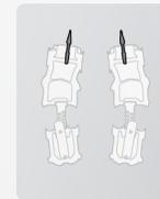
**Monozacker Steigeisen** sind vor allem für technisch schwierige Eisfälle interessant, wenn Präzision gefordert ist. Sie ermöglichen ein präziseres Stellen der Füße, erleichtern das Drehen des Fußes und bieten besseren Halt auf kleinen Hooks, (z.B. auch im Fels).
