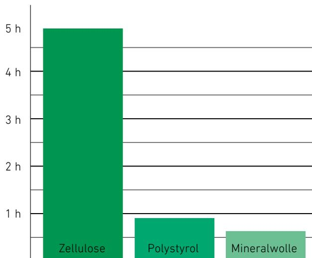
Für das Kühlen von Gebäuden wird viel mehr Energie verbraucht als für das Heizen. Die Phasenverschiebung gibt die Zeitspanne an, die eine Temperaturwelle benötigt, um von der Außenseite eines Bauteils auf die Raumseite zu gelangen. Je größer die Phasenverschiebung, desto länger wird das Aufheizen des Gebäudeinneren verhindert.
