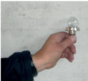
Beim Auswechseln von Glühlampen dürfen keinesfalls die Einstellschrauben des Scheinwerfers gelöst werden. Achten Sie darauf, dass die Volt-/Wattangaben der neuen mit denen der defekten Glühlampe übereinstimmen. Glühlampen sind nur mit sauberen Lappen oder dem Verpackungskarton anzufassen. Fett auf dem Lampenkörper verdunstet durch die Hitze und hat dadurch die Trübung des Reflektors zur Folge. Verbrauchte Reserven sind sofort wieder zu ersetzen.
