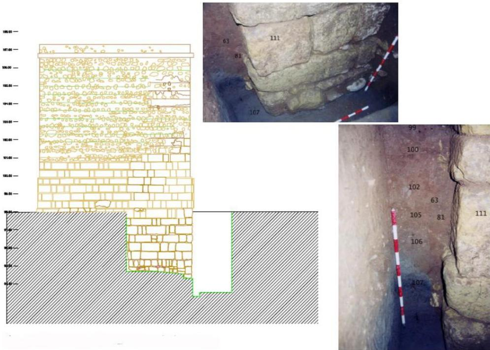
Fig. 13. Corte 8. Cimentación de la torre
