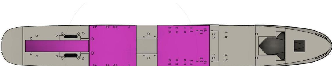
Bei der Aufschleppe am Heck empfehlen wir den Einsatz von Magneten um diese auf Position zu halten und im RC-Einsatz einen Zugang zur Rudermechanik zu erhalten.
