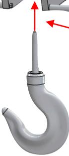
Rundmaterial 0,3mm einkleben und ca. 2 mm überstehen lassen und das überstehende Material mit dem LötKolben leicht anschmelzen so dass ein Nietkopf entsteht.
