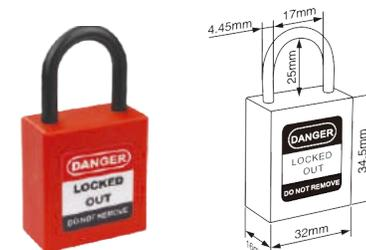
El cuerpo de nylon reforzado es capaz de soportar temperaturas que oscilan entre -20°C y +120°C. El grillete no conductor esta hecho de nylon. Asimismo, presenta una función de retención de llaves: cuando el grillete se encuentra desbloqueado, la llave no puede ser retirada.
