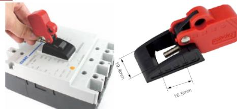
Hecho de nailon PA reforzado con plástico de ingeniería, la temperatura puede admitir un candado con un diámetro de arco de hasta 8 mm. Resistencia -20°C a +120°C. Fácil de instalar, no se necesitan herramientas.
