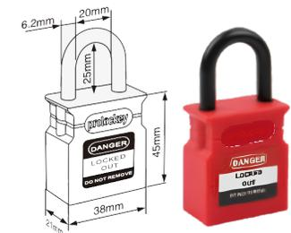
El cuerpo de nylon reforzado es capaz de soportar temperaturas que oscilan entre -20°C y +120°C. El grillete no conductor esta hecho de nylon. Asimismo, presenta una función de retención de llaves: cuando el grillete se encuentra desbloqueado, la llave no puede ser retirada.
