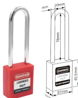
El cuerpo de nylon reforzado es capaz de soportar temperaturas que oscilan entre -20°C y +120°C. El grillete de acero está recubierto de cromo. Asimismo, presenta una función de retención de llaves: cuando el grillete se encuentra desbloqueado, la llave no puede ser retirada.
