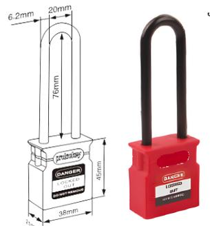
El cuerpo de nylon reforzado es capaz de soportar temperaturas que oscilan entre -20°C y +120°C. El grillete no conductor está hecho de nylon. Asimismo, presenta una función de retención de llaves: cuando el grillete se encuentra desbloqueado, la llave no puede ser retirada.
