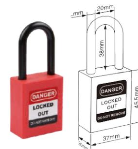
El cuerpo de nylon reforzado es capaz de soportar temperaturas que oscilan entre -20°C y +120°C. El grillete no conductor esta hecho de nylon. Asimismo, presenta una función de retención de llaves: cuando el grillete se encuentra desbloqueado, la llave no puede ser retirada.
