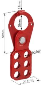
Hecho de acero endurecido con recubrimiento en polvo, duradero y resistente al óxido. Tiene una disposición de doble bloqueo. Los ganchos en las mordazas evitan que se separen. Orificios de bloqueo: 1.2 cm de diámetro. Grillete de acero 1" (2.5 cm).
