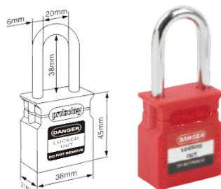
Cuerpo de nailon reforzado. Función emergente: el grillete aparecerá automáticamente al desbloquearlo. Presione el grillete al bloquear, no se necesita llave para el grillete de acero. El grillete de acero está cromado; el grillete no conductor es insertar y sacar.
