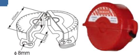
Fabricado en ABS duradero, resistente a temperaturas de -20 °C a +90 °C, sin metales. vez bloqueado, cubre completamente alrededor del volante e impide que gire el volante de la válvula. (457-635mm)
