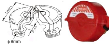
Fabricado en ABS duradero, resistente a temperaturas de -20 °C a +90 °C, sin metales. vez bloqueado, cubre completamente alrededor del volante e impide que gire el volante de la válvula. (64-127mm)
