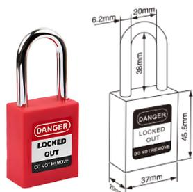
El cuerpo de nylon reforzado es capaz de soportar temperaturas que oscilan entre -20°C y +120°C. El grillete de acero está recubierto de cromo. Asimismo, presenta una función de retención de llaves: cuando el grillete se encuentra desbloqueado, la llave no puede ser retirada.
