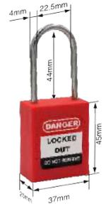
El cuerpo reforzado de nylon es capaz de soportar temperaturas que oscilan entre -20°C y +120°C. El grillete de acero, recubierto de cromo, incorpora una función de retención de llaves que evita que la llave se extraiga cuando el grillete está desbloqueado.
