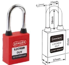
El cuerpo de nylon reforzado es capaz de soportar temperaturas que oscilan entre -20°C y +120°C. El grillete de acero está recubierto de cromo. Asimismo, presenta una función de retención de llaves: cuando el grillete se encuentra desbloqueado, la llave no puede ser retirada.
