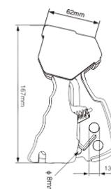
Cuerpo de la cerradura: fabricado en nylon reforzado con fibra de vidrio, resistente a productos químicos.
