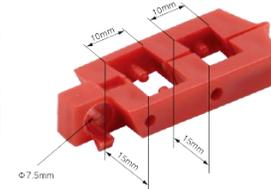
Hecho de nailon PP reforzado con plástico de ingeniería. Para disyuntores de 120 V que tienen orificios en la lengüeta del interruptor. Uso rápido y fácil: simplemente colóquelo en su lugar y aplique el candado.  $5.5\text{cm} \times 0.9\text{cm} \times 2.1\text{cm}$
