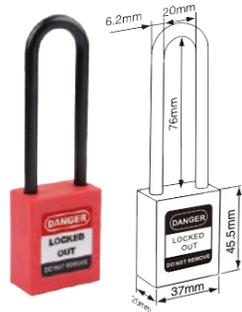
El cuerpo de nylon reforzado es capaz de soportar temperaturas que oscilan entre -20°C y +120°C. El grillete no conductor esta hecho de nylon. Asimismo, presenta una función de retención de llaves: cuando el grillete se encuentra desbloqueado, la llave no puede ser retirada.
