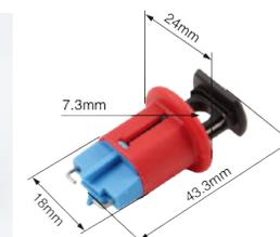
Hecho de nailon PA reforzado con plástico de ingeniería. Fácil de instalar, no se necesitan herramientas. Disponible para disyuntores unipolares y multipolares. Pin interior estándar
