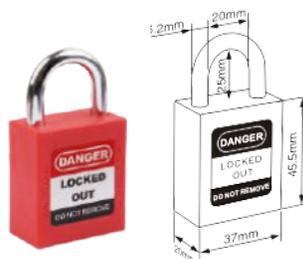
El cuerpo de nylon reforzado es capaz de soportar temperaturas que oscilan entre -20°C y +120°C. El grillete de acero está recubierto de cromo. Asimismo, presenta una función de retención de llaves: cuando el grillete se encuentra desbloqueado, la llave no puede ser retirada.
