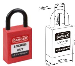
El cuerpo de nylon reforzado es capaz de soportar temperaturas que oscilan entre -20°C y +120°C. El grillete no conductor esta hecho de nylon. Asimismo, presenta una función de retención de llaves: cuando el grillete se encuentra desbloqueado, la llave no puede ser retirada.
