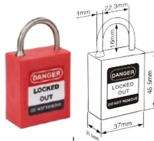
El cuerpo reforzado de nylon es capaz de soportar temperaturas que oscilan entre -20°C y +120°C. El grillete de acero, recubierto de cromo, incorpora una función de retención de llaves que evita que la llave se extraiga cuando el grillete está desbloqueado.
