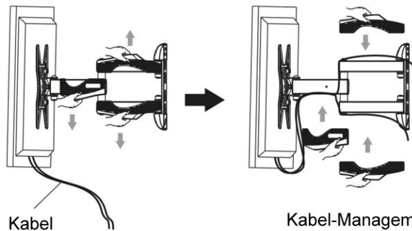
Kabel-Management Clips zur optimalen Verlegung der Kabel entlang der Arme
