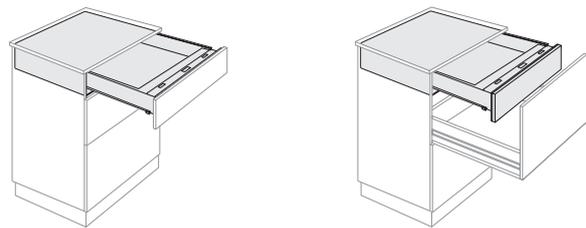
Die montierte Holzfront soll bündig mit dem Schrank abschließen
